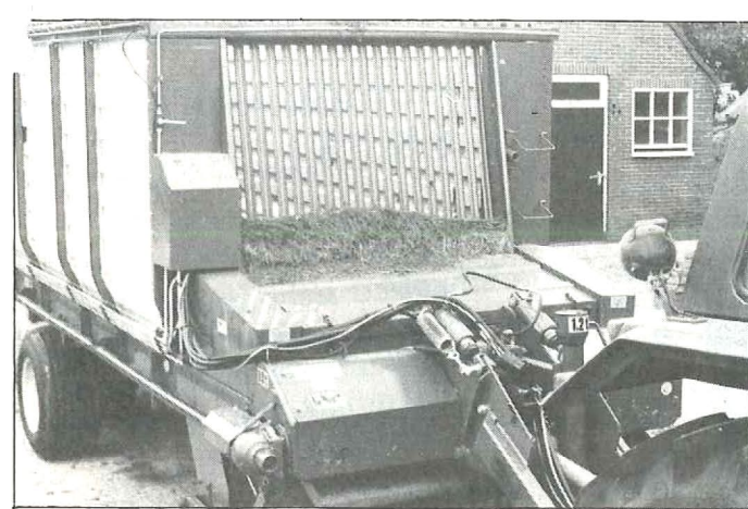
Afb. 9 Elektrische bediening van een opraapdoseerwagen. Olieslangen en elektrische kabels gaan als één pakket naar de verdeelkast op de wagen.
