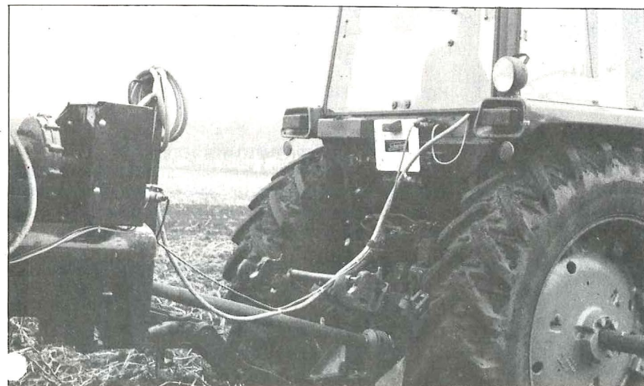
Afb. 11 Elektrische afstandsbediening bij een aardappelrooier. De gehele hydraulische installatie is op de rooier gemonteerd. De pomp wordt door de aftakas aangedreven: de dikke kabel vanuit de verbinding tussen het schakelkastje in de cabine en de regelblokken op de machine. De dunne kabel verzorgt de elektrische voeding van de regelschuiven.
